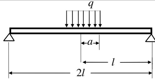
(b) 若利用(a)小題之解求承受圖(二)之集中荷重 P 作用下的撓度曲現時，應如何做極限逼近求取？
