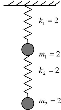
(a) 求出此一結構系統之基本振態積特徵頻率。
